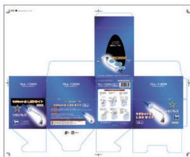
LEDライトBOX展開図 縮尺や実寸の試作をした後に展開図に版データを重ねる
